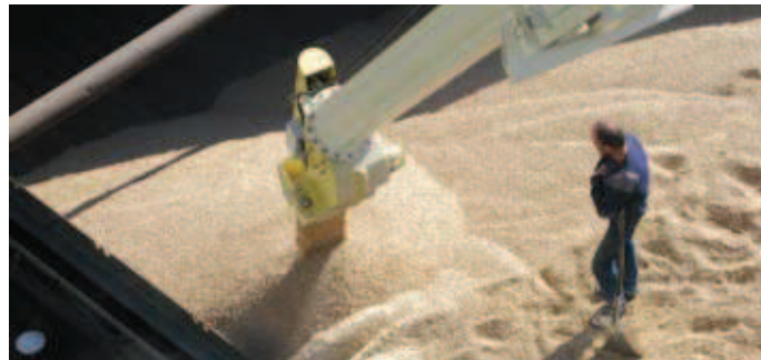
Staubarme Beladung von Schiffen | Bild: NEUERO Industrietechnik
